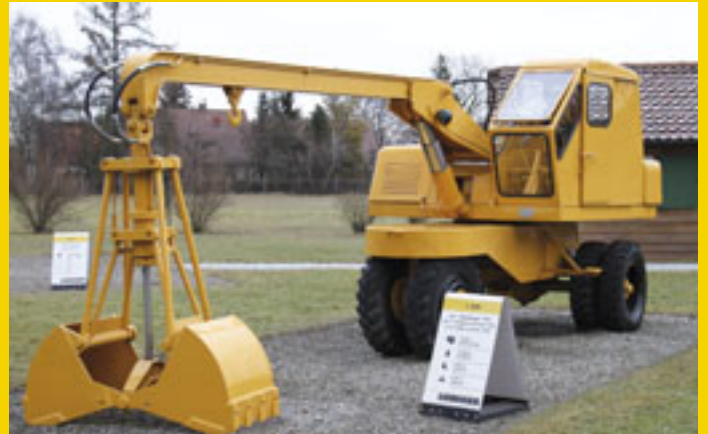
Liebherrin kaivukonemallia vuodelta 1954. Liebherr I 300 painaa 7,5 tonnia ja operoi 300 litran kauhalla. Moottoritehokin huikaut 18 kilowattia. Koneen takana näkyy puutalo, jossa Hans Liebherr asui ja aloitti myös nosturien valmistuksen 40-luvun lopulla. Talo on säilytetty ja entisöity keskelle Kirchdorfin tehdasalueetta.
