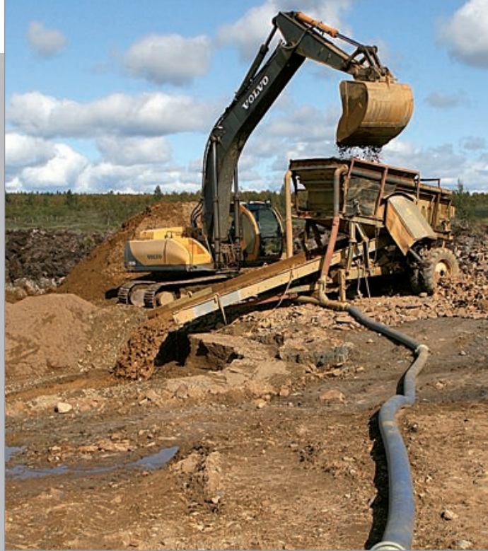
Tauno Leino Volvoineen Korhosenojalla. Rännittämiseen vettä tarvitaan runsaasti. Seulan syöttö tapahtuu kauhalla varistamalla. Mitä vähemmän koneissa on kuluvia osia, sen parempi.
