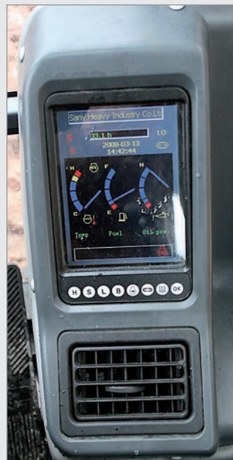
Selkeä monitori kertoo oleellista dataa koneen toiminnoista. Alareunan näppäimet H, S, L ja B ovat ennalta säädettyjä työalueita.
