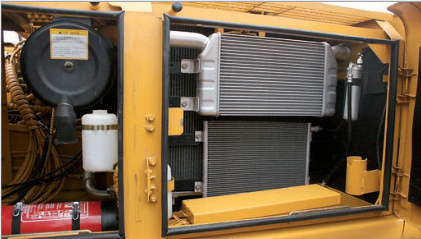
Reilut huoltoluukut koneen sivussa tarjoavat esteettömän pääsyn esim. jäähdyttimen suojaverkkoa puhdistamaan.
