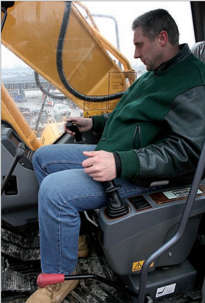
Kaivuhydrauliikka on käteen sopiva. Varustukseen kuuluu niin tyhjäkäyntiautomaatiikka kuin hetkellisesti lisävoimaa tuova power-nappi kaivuvivun päässä.
